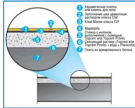
Фрагмент: гидроизоляция непосредственно на стяжке с уклоном
