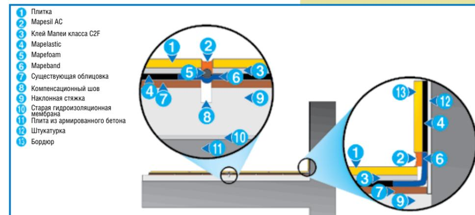
Фрагмент: гидроизоляция компенсационного шва
