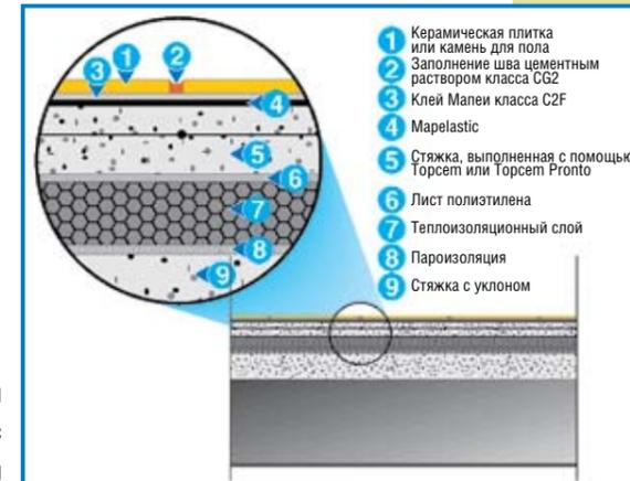
Фрагмент: гидроизоляция балкона с теплоизоляцией
