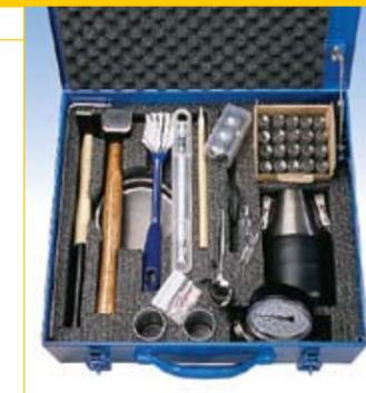
Инструмент для измерения содержания остаточной влажности в стяжках, действующий на основе химической реакции. Вода вступает в реакцию с карбидом кальция и образует газ ацетилен, который увеличивает давление. Уровень влажности определяется давлением, которое показывает манометр. Гидрометр поставляется в пластиковом футляре, который содержит:
