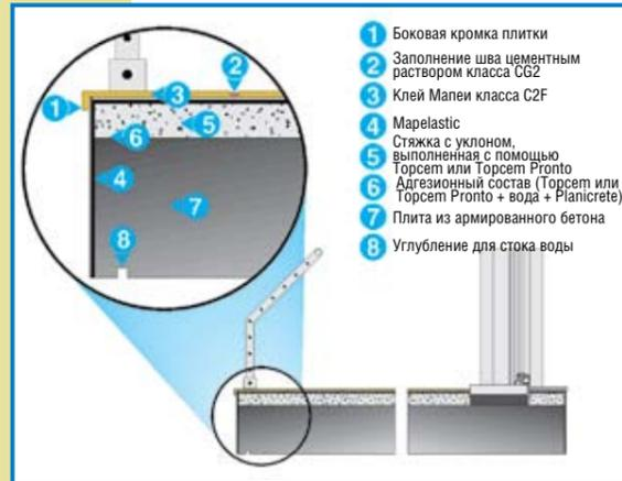
Фрагмент: гидроизоляция передней части балкона
