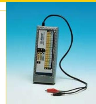
Электронный прибор для быстрого определения процентной влажности, содержащейся в стяжках из бетона (шкала А), стяжках на основе Маресет (шкала В) или на основе ангидридного гипса (шкала С). Гидрометр получает питание от батареек мощностью 9В и поставляется в футляре, который содержит:
