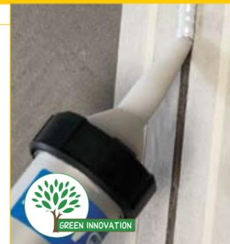
Однокомпонентный тиксотропный быстротвердеющий полиуретановый клей-герметик с высоким модулем эластичности для швов с рабочим расширением / сжатием до 20%.
