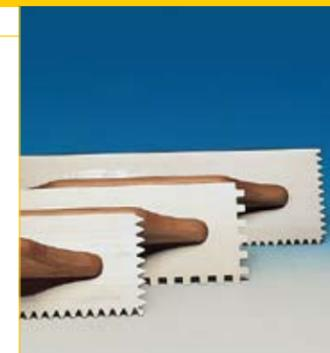
Металлический шпатель зубчатостью 3
