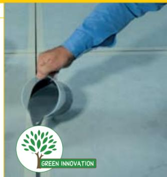
Двухкомпонентный самовыравнивающийся полиуретановый герметик для горизонтальных швов с рабочим расширением/сжатием до 10%.
