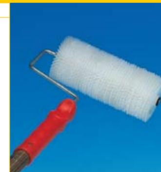
Пластиковый валик с ручкой (ширина 23 см, диаметр 8 см). Используется для улучшенного нанесения выравнивающих составов с толщиной слоя от 2 до 15 мм, помогает избежать образования пузырьков воздуха и улучшить внешний вид поверхностей, образованных с помощью самовыравнивающихся составов производства MAPEI.
