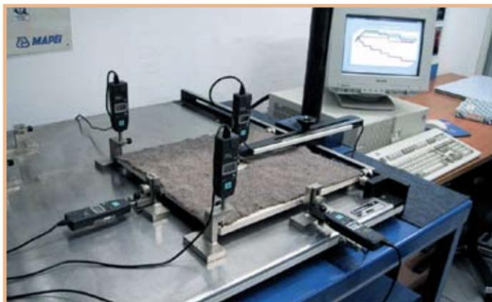
Рис.1 Тест на влажность с помощью фетровой ткани.
