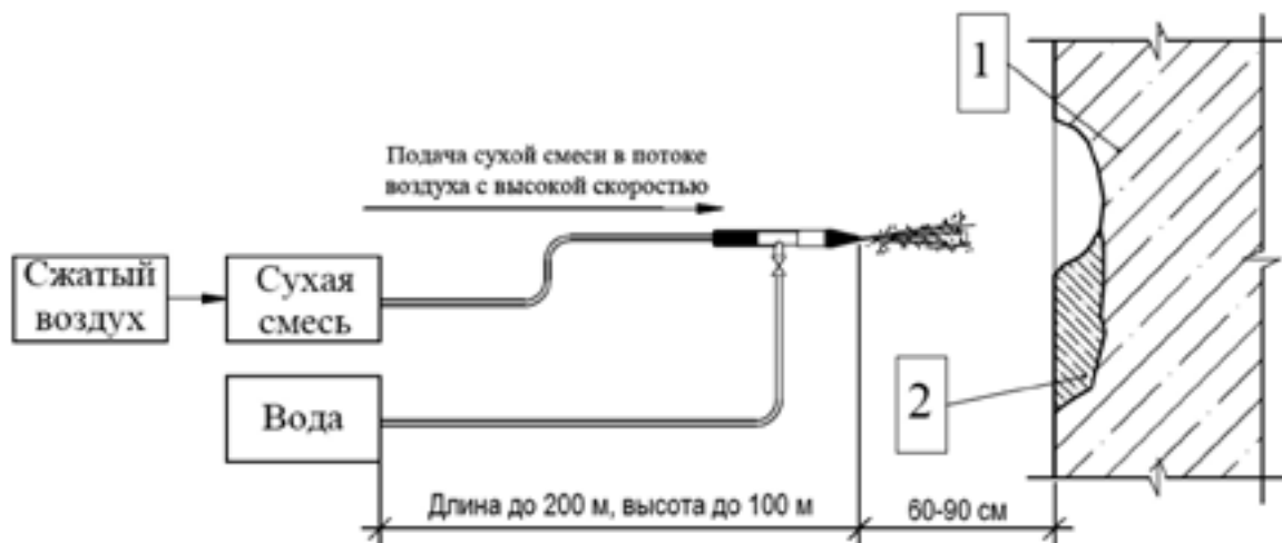
Рисунок 6.30 – Принципиальная схема сухого торкретирования
