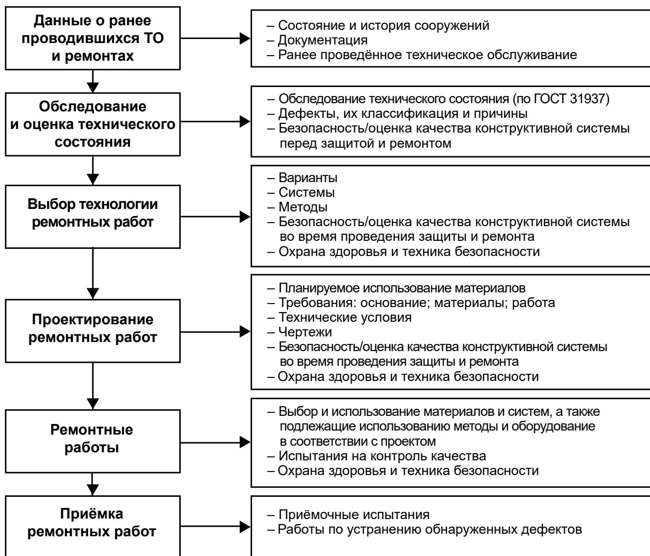
Рисунок 5.1 – Этапы стандартного проекта по ремонту
