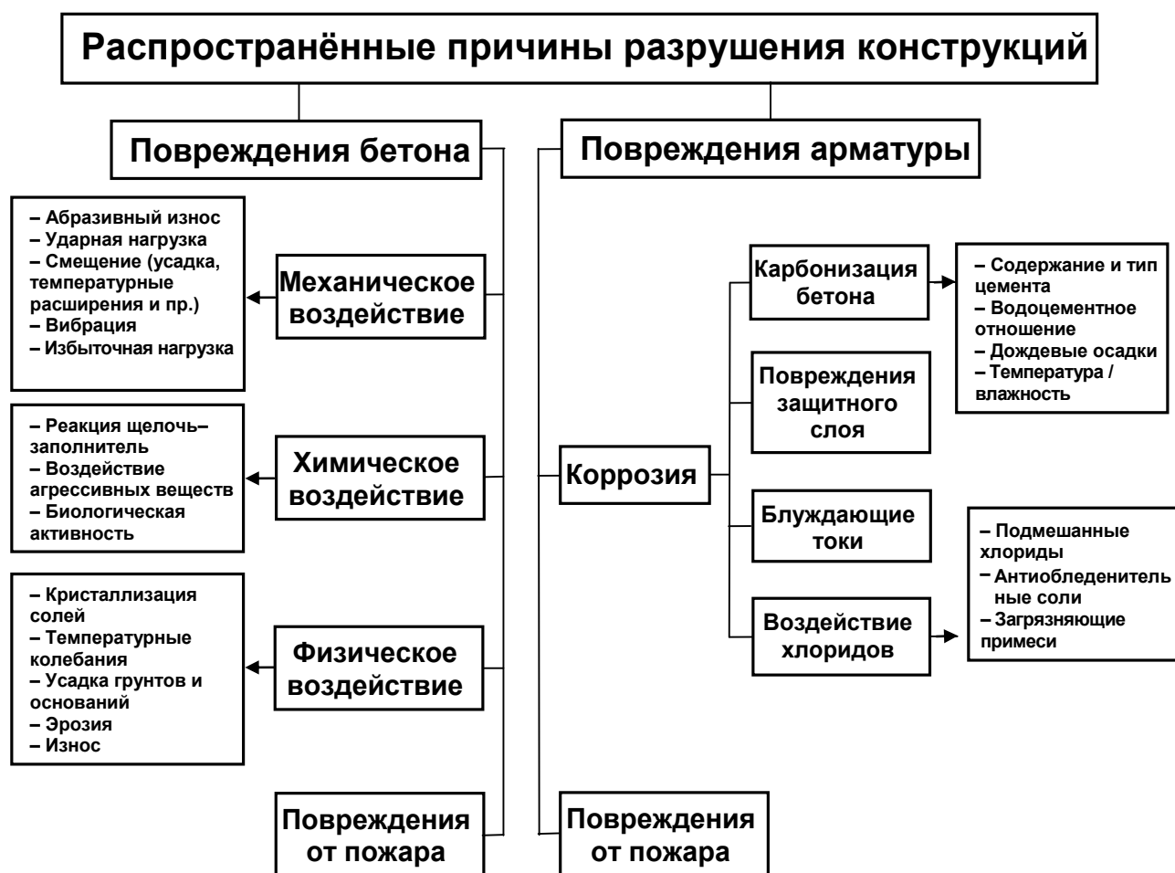
Рисунок 5.2 – Распространённые причины разрушений конструкций
