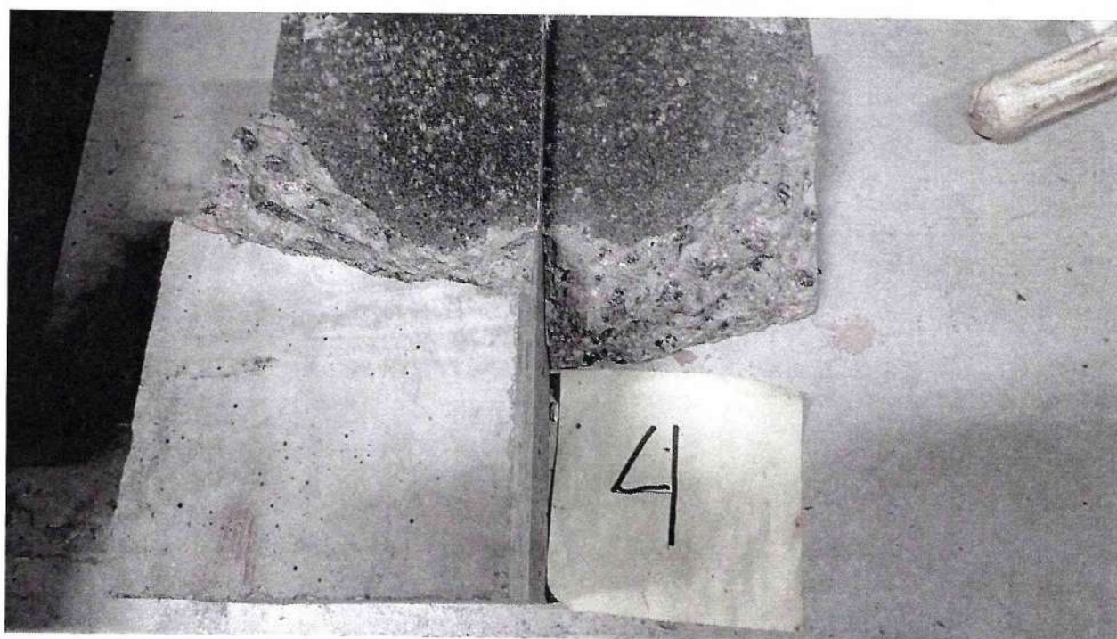
Рисунок 4 – Образец 58/1 МДС № 4, испытанный по ГОСТ Р 59180-2021. Определение прочности сцепления при сдвиге, при температуре 23 °С
