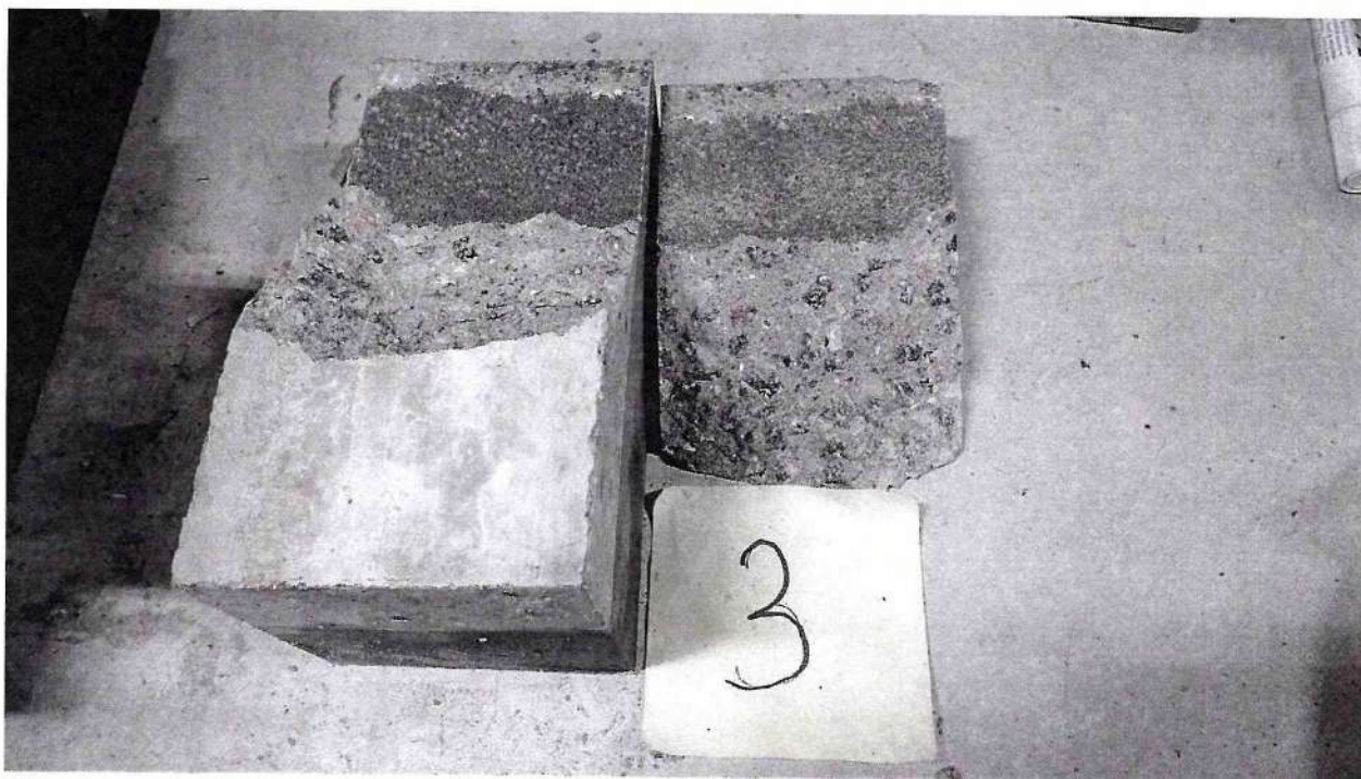
Рисунок 3 – Образец 58/1 МДС № 3, испытанный по ГОСТ Р 59180-2021. Определение прочности сцепления при сдвиге, при температуре 23 °С
