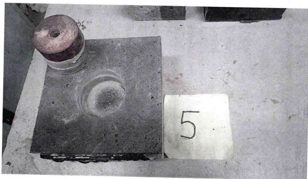
Рисунок 4 – Образец 58/3 МДС № 5, испытанный по ГОСТ Р 59180-2021. Определение прочности сцепления при отрыве, при температуре 23 °С
