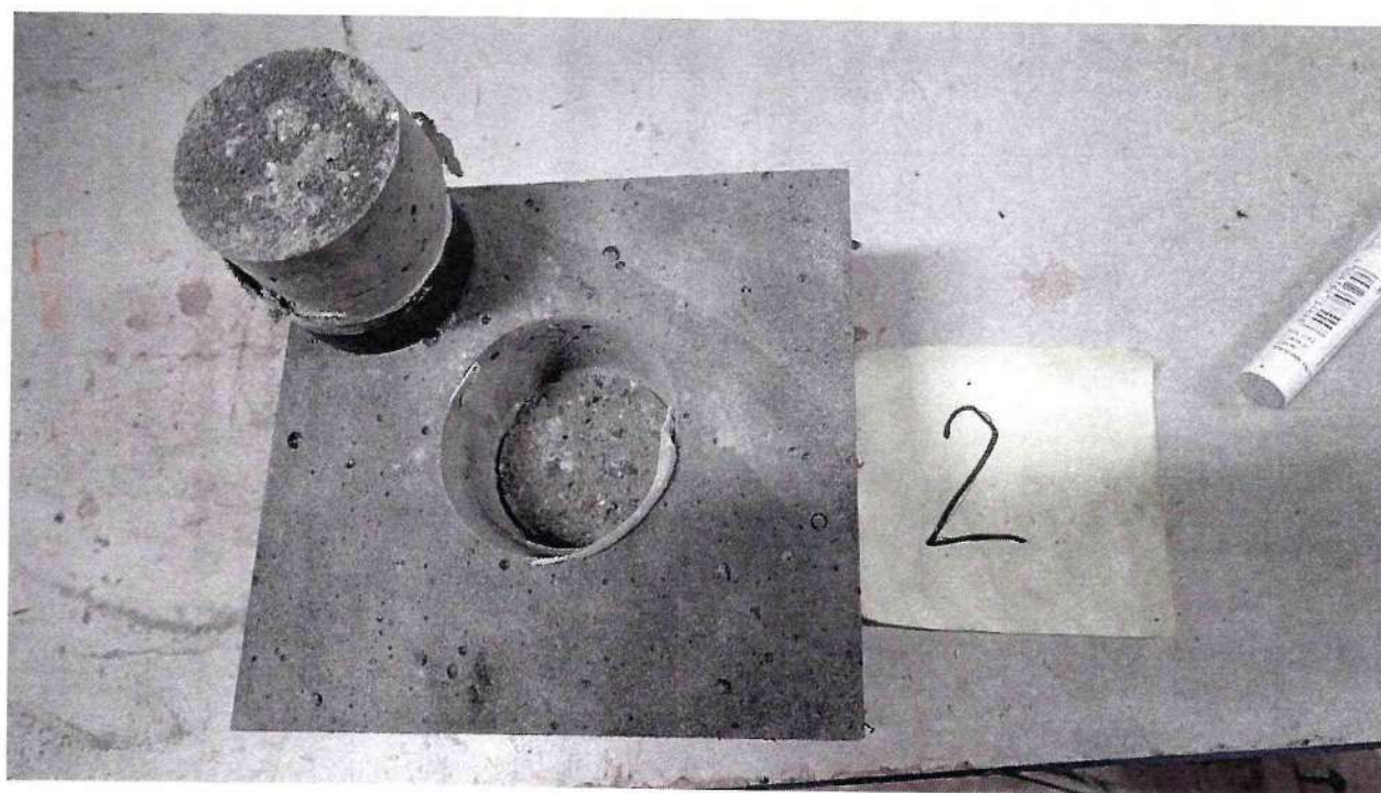
Рисунок 2 – Образец 58/3 МДС № 2, испытанный по ГОСТ Р 59180-2021. Определение прочности сцепления при отрыве, при температуре 23 °С
