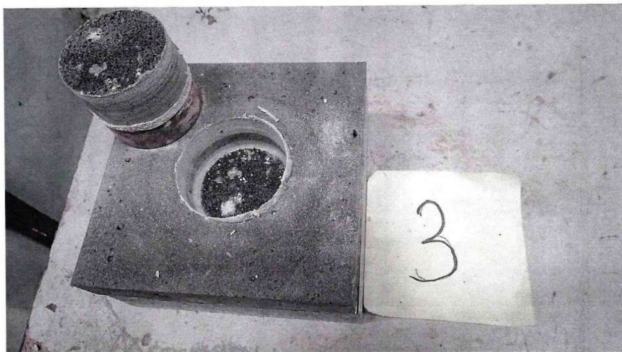
Рисунок 2 – Образец 58/3 МДС № 3, испытанный по ГОСТ Р 59180-2021. Определение прочности сцепления при отрыве, при температуре 23 °C
