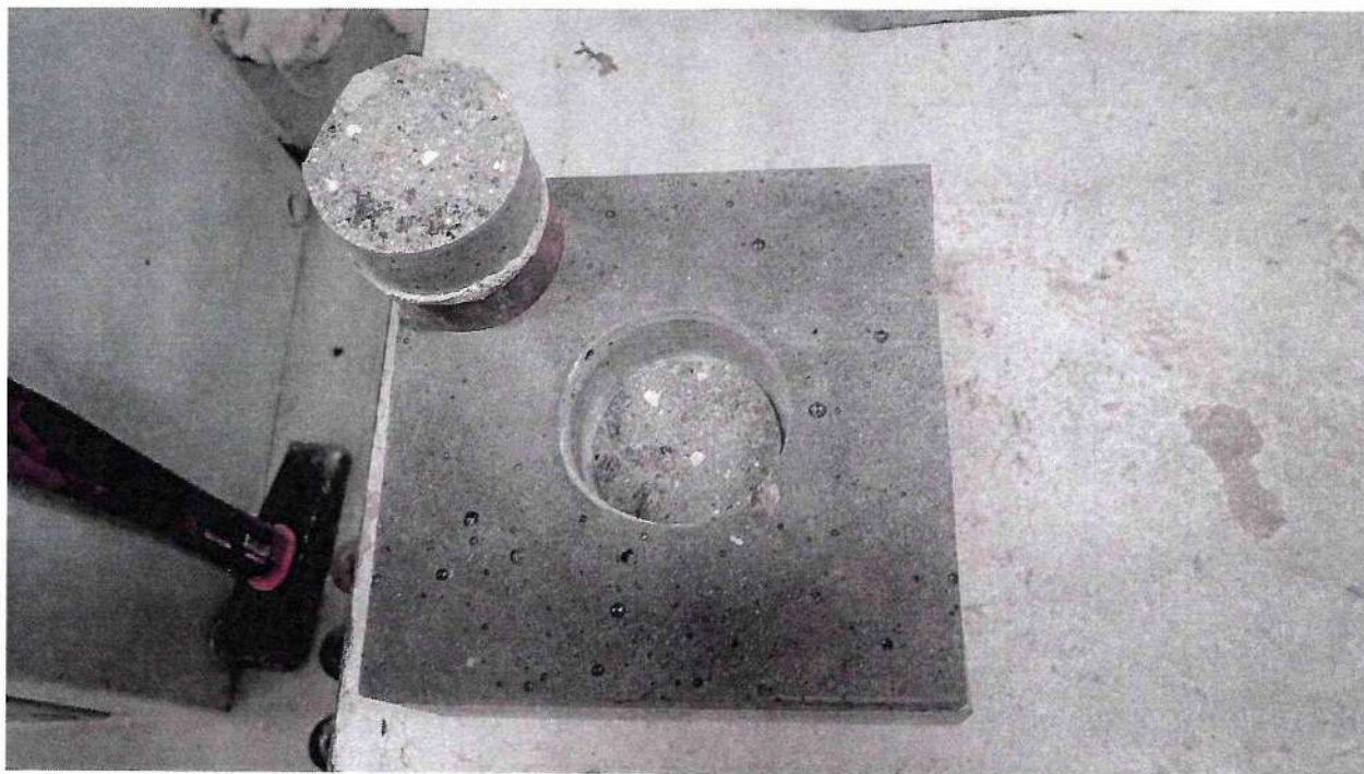
Рисунок 5 – Образец 58/3 МДС № 5, испытанный по ГОСТ Р 59180-2021. Определение прочности сцепления при отрыве, при температуре 23 °С
