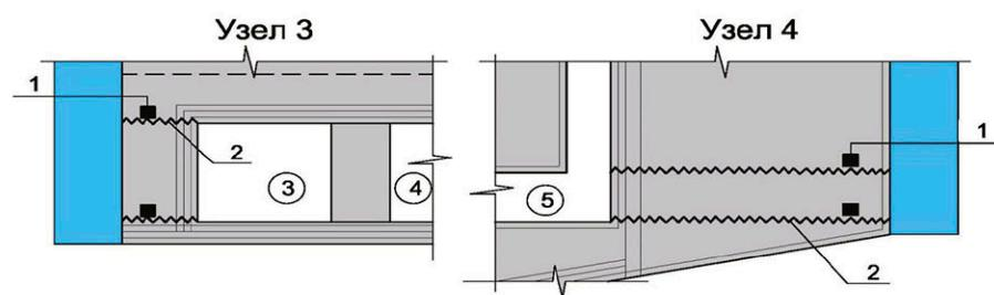
Рисунок 7.1.11 - Типовые узлы гидроизоляции в потернах, цементационных галереях и соединительных коридорах (узлы 3 и 4 на рис. 7.1.10):
