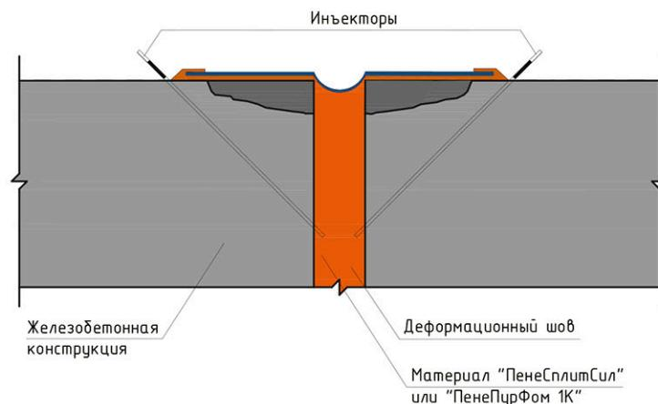
Рисунок 7.3.15 - Заполнение полости шва инъекционными смолами.
