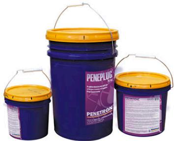
4.2.3. «Пенеплаг» - сухая строительная гидроизоляционная поверхностная смесь, предназначенная для мгновенной остановки течей, за счёт расширения при быстром схватывании и последующем твердении. «Пенеплаг» производится согласно ТУ 5745-77921756-2006 (технические характеристики см. табл. 4.2.3).
