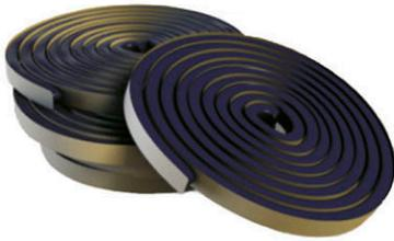
4.2.6 «Пенебар» - гидроизоляционный, гибкий, полимерный гидроактивный, саморасширяющийся жгут прямоугольного сечения, предназначен для гидроизоляции технологических (рабочих) швов бетонирования при строительстве зданий и сооружений, а также для гидроизоляции мест ввода инженерных коммуникаций как при строительстве, так и при выполнении ремонтных работ. При взаимодействии с водой гидроизоляционный жгут способен разбухать до 300%. При наличии воды
