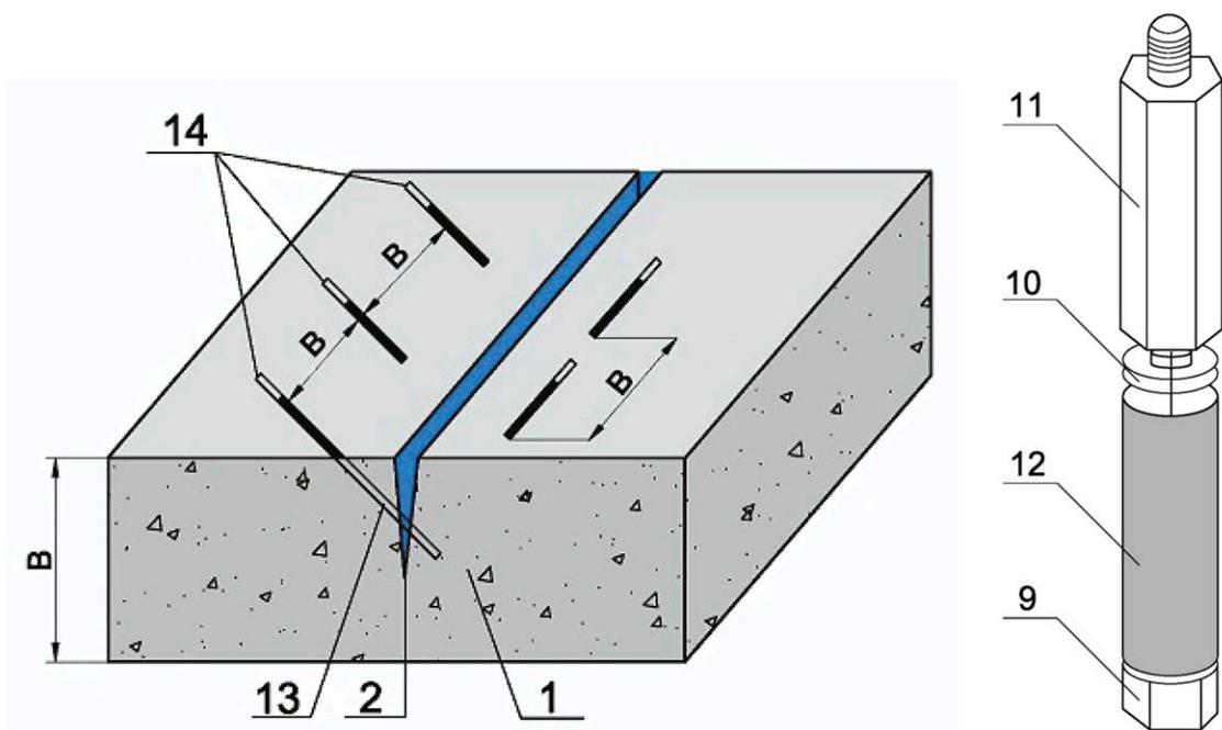
Рисунок 7.4.8 - Заполнение каверн, пустот и полостей в железобетонных конструкциях: 1 - железобетонная конструкция; 2 – водонесущая статичная трещина; 3 – арматура; 4 – гидропломба «Ватерплаг» («Пенеплаг»); 5 – инъектор; 6 – «Пенетрон»; 7 – «Скрепа М500 Ремонтная»; 8 – «Скрепа М600 Инъекционная»; 9 – болт с отверстием; 10 – прижимное кольцо (шайба); 11 – трубка инъектора; 12 – резиновый уплотнитель; 13 – шпур для установки инъектора; 14 – установка инъекторов в шахматном порядке.
