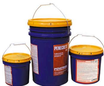
4.2.2. «Пенекрит» - сухая строительная гидроизоляционная поверхностная смесь, предназначенная для гидроизоляции статичных трещин, швов,стыков, вводов коммуникаций, сопряжений и примыканий за счёт высокой водонепроницаемости и отсутствия усадки самого материала. «Пенекрит» производится согласно ТУ 5745-001-77921756-2006. Обладает высокой адгезией к бетону, металлу, камню и другим материалам. Характеризуется удобоукладываемостью, высокой прочностью (технические характеристики см. табл. 4.2.2).
