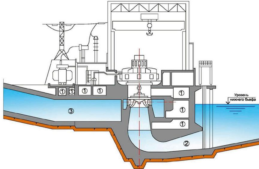
*Рисунок 6.1.3 - Поперечные разрезы по зданиям малых ГЭС:
