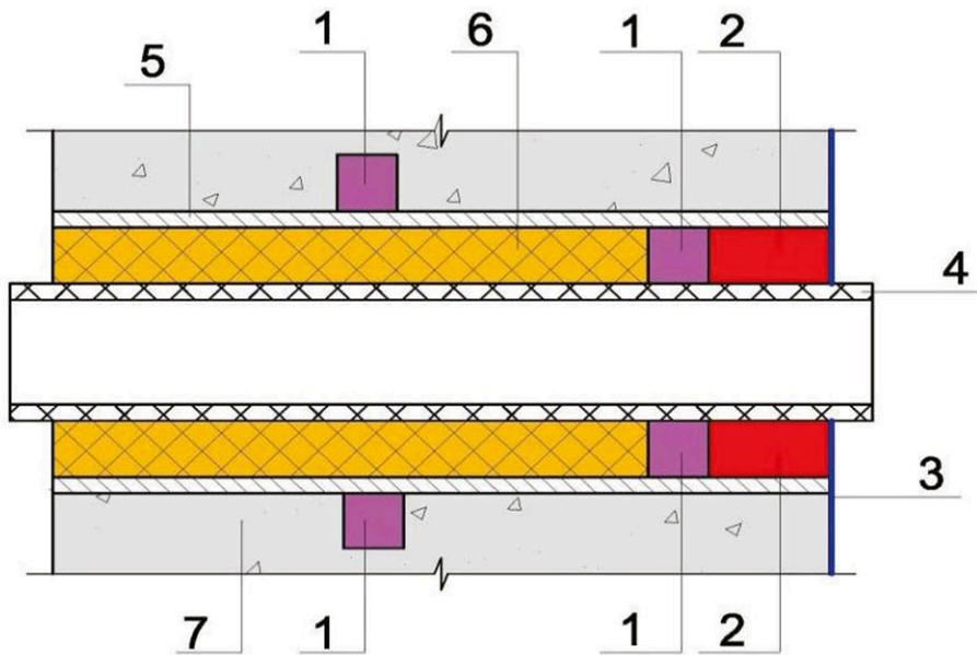
*Рисунок 7.1.12 - Гидроизоляция места ввода коммуникаций:*
